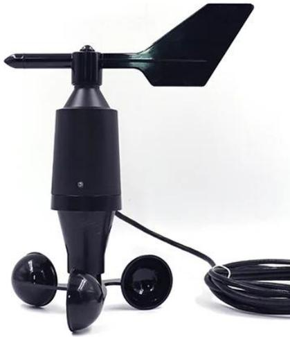
Le logiciel interface un anémomètre de type RY-FSX. La communication se fait en RS485 au protocole ModBusRTU via un câble à 4 fils. Ces fils sont à raccorder sur le connecteur RS485 en respectant les couleurs.
