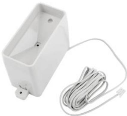
Ce pluviomètre à godets génère une boucle sèche à chaque basculement de godet. Le logiciel compte le nombre de boucles pendant chaque période. La connexion n'est pas polarisée, les deux fils du pluviomètre sont à raccorder sur le connecteur à 2 broches.
