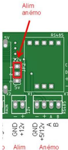
Le cavalier d'alimentation doit être sur la position 12V.
