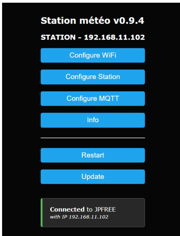
Il est possible d'effacer l'ensemble des paramètres (retour paramètres usine) en connectant puis coupant l'alimentation dès le démarrage du clignotement rapide, et ce 6 fois de suite.
