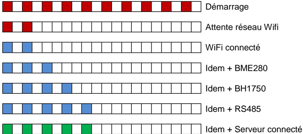
Lorsque le serveur est connecté au réseau, il est possible d'accéder à la page de configuration par l'url <http://station.local> où **station** sera remplacé par le nom de la station.
