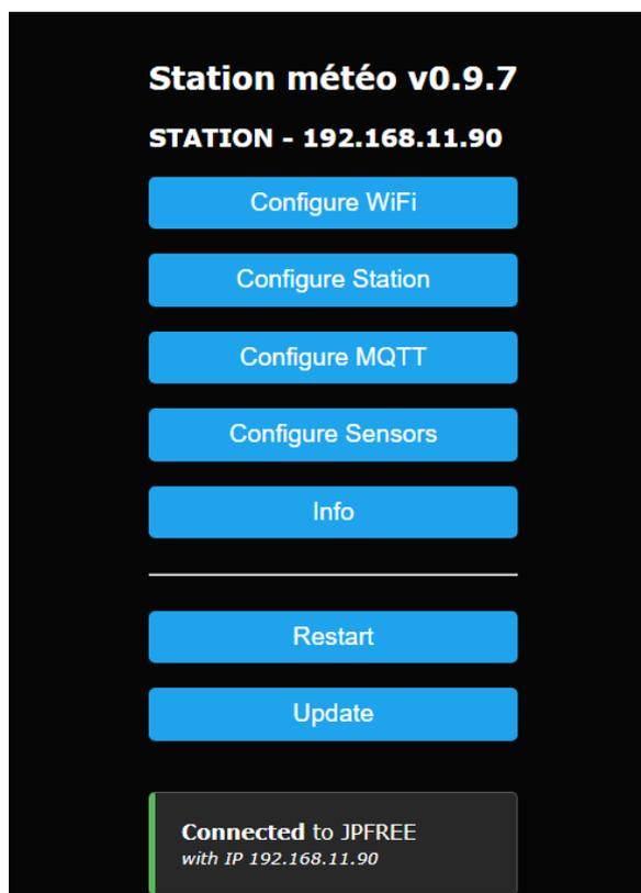
Il est possible d'effacer l'ensemble des paramètres (retour paramètres usine) en connectant puis coupant l'alimentation dès le démarrage du clignotement rapide, et ce 6 fois de suite.
