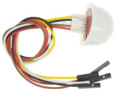
Ce capteur est alimenté en 5V et sera raccordé sur le connecteur I2C 5V.
