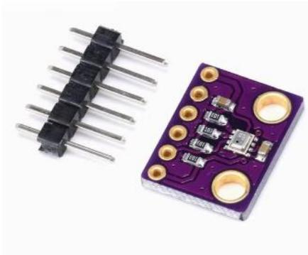
Ce capteur est alimenté en 3V3 et sera raccordé sur le connecteur I2C 3V3.
