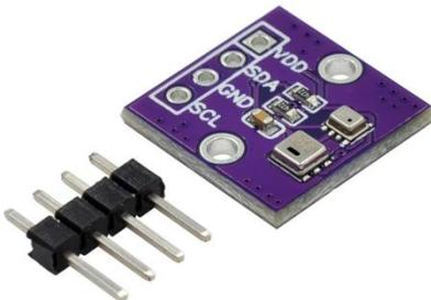
Ce capteur hybride est alimenté en 3V3 et sera raccordé sur le connecteur I2C 3V3. Il remplace le capteur BME180.
