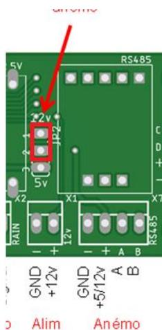
Le cavalier d'alimentation doit être sur la position 12V.
