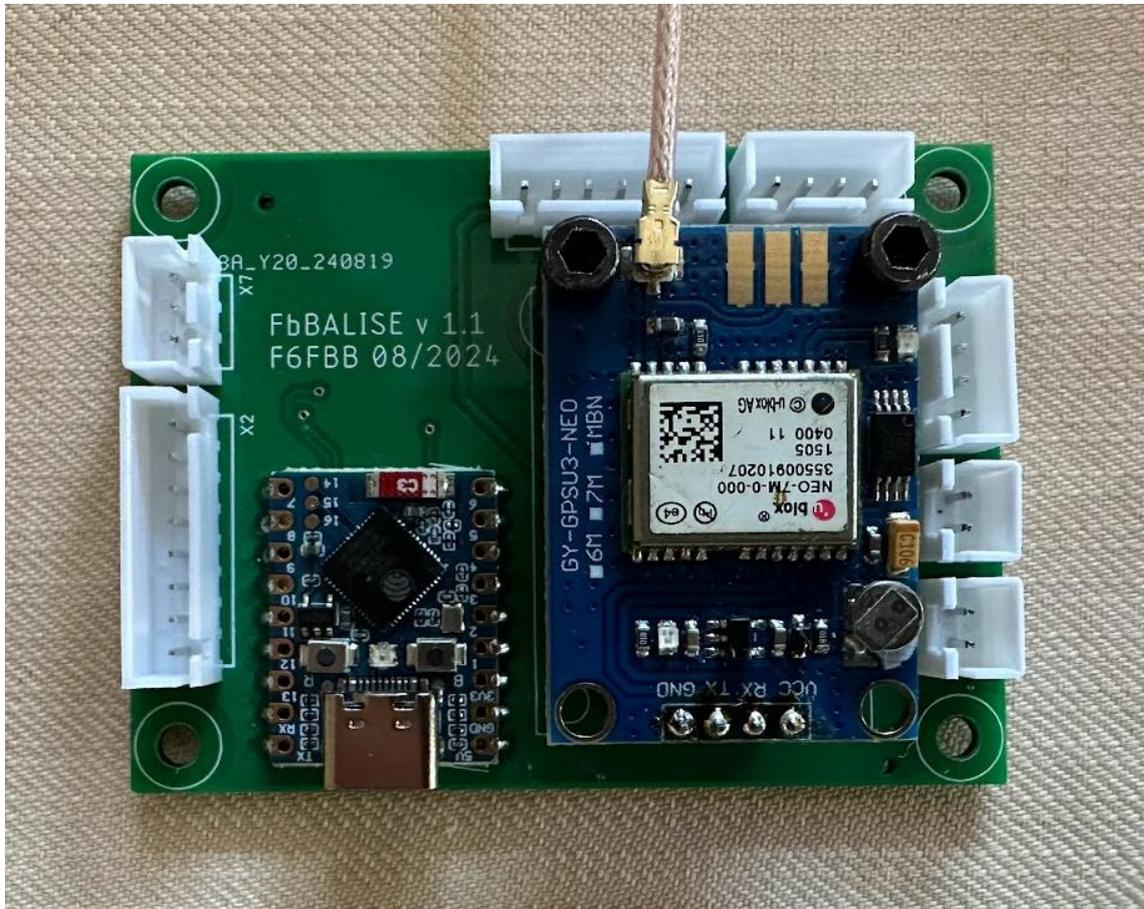
Il permet de générer des séquences programmées par script et enregistrées en mémoire flash. Une interface WEB permet créer ou modifier les scripts et configurer le système. La taille maximale d'un script est 4K caractères.
