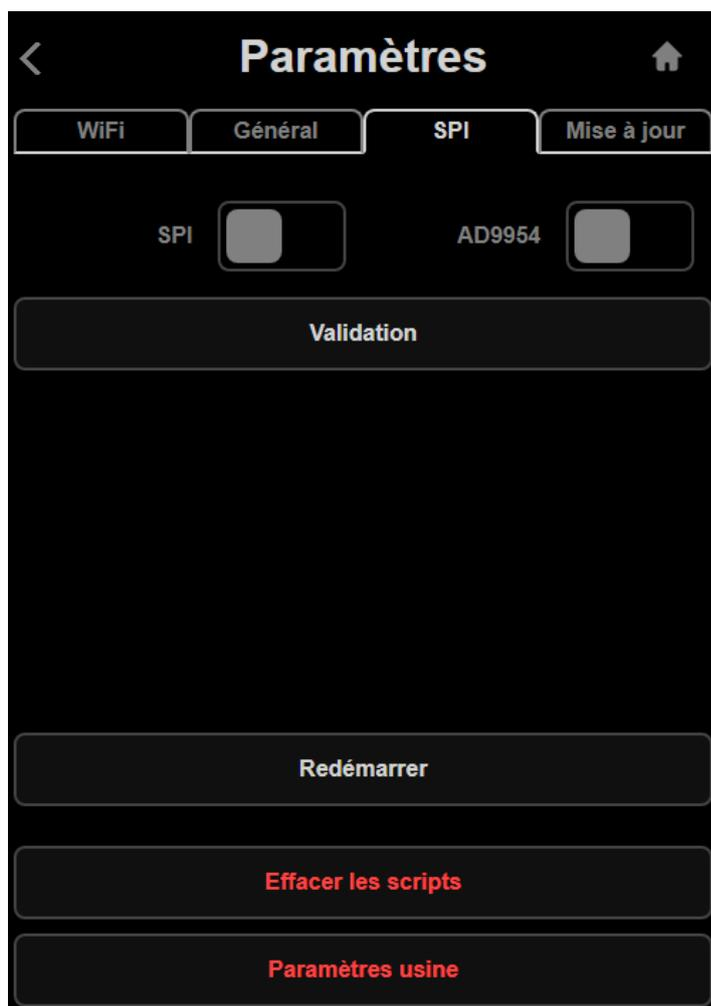
Si les deux switches SPI et AD9954 sont validés, La page de configuration SPI permet de programmer un DDS de type AD9954. Cf [§12](#).
