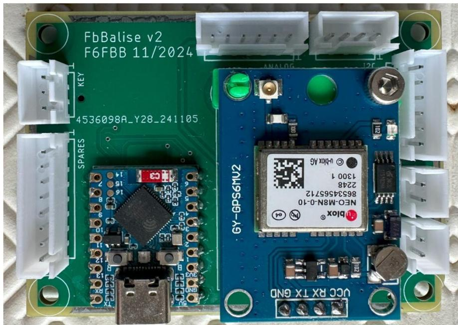
Il permet de générer des séquences programmées par script et enregistrées en mémoire flash. Une interface WEB permet créer ou modifier les scripts et configurer le système. La taille maximale d'un script est 4K caractères.
