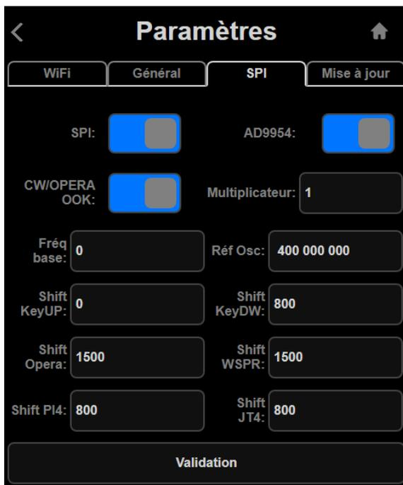
La valeur de la fréquence de base doit être renseignée. La fréquence maximale est de 160 000 000 Hz.
